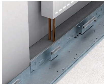
Verwendung des Estrichabgrenzungsprofils Bei beidseitig verlegtem Estrich das Estrichabgrenzungsprofil an der Wandseite des Kanalsystems montieren.
